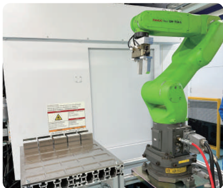
▲マシンニングセンターに協働ロボットを組み合わせた様子
