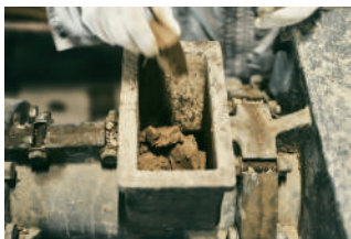
▲越前瓦の製造工程
